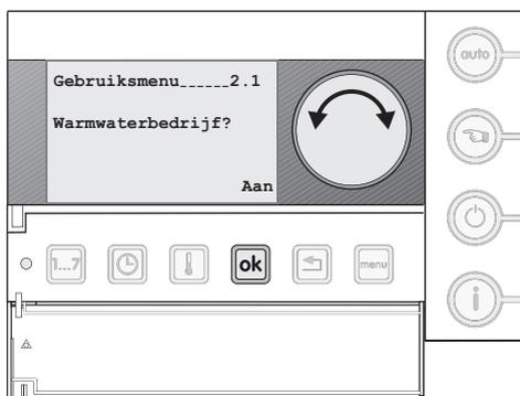
Fig. 29 Set-up DHW operation
