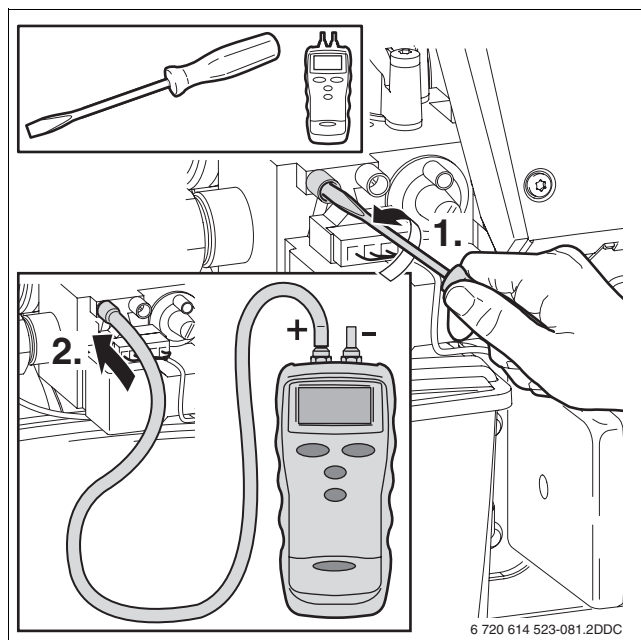
Afb. 40 Meten dynamische gasvoordruk
